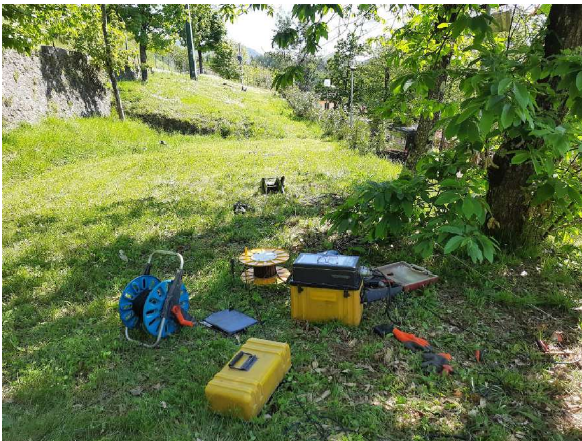
Vista parziale dell'array sismico con al centro la postazione centrale G12/13 ed il prospettore S24
