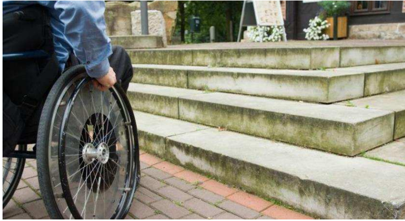
Esempio di barriera fisica intrinseca
